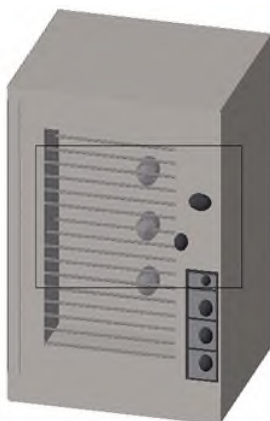
Рисунок 2.52 – Модель конвекційної шафи з органами управління
