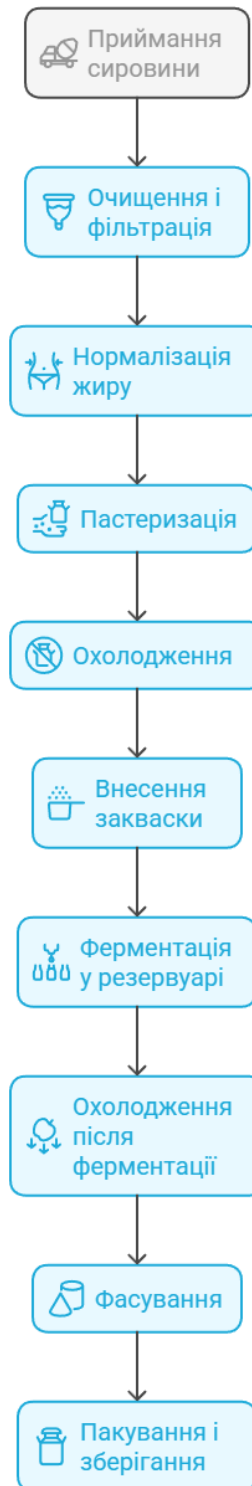
Рис. 2.1 Горизонтальна декомпозиція технологічної системи виробництва сметани
