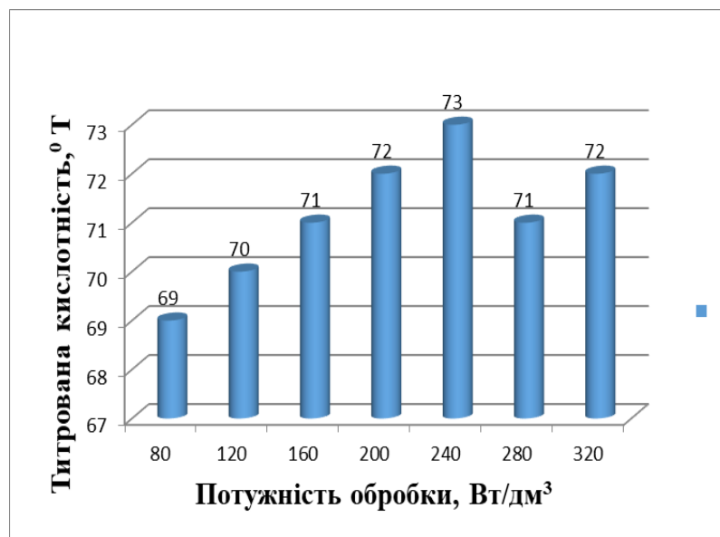
Рис. 1.15. Динаміка титрованої кислотності у зразках молока при тривалості ультразвукової обробки 60 секунд та різній потужності
