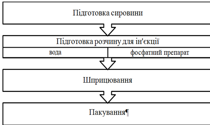
Рис. 3.13. Технологічна схема виробництва напівфабрикатів з м'яса птиці з використанням активованих рідких середовищ
