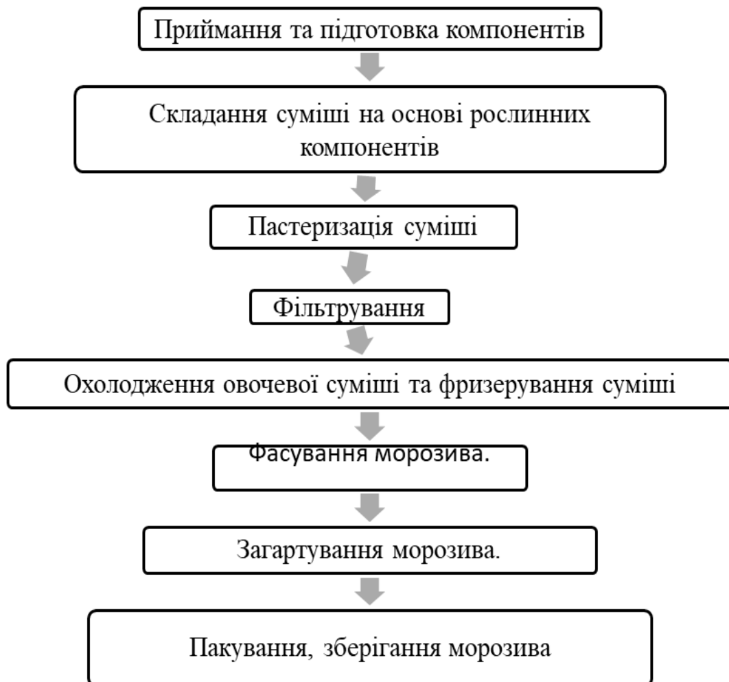
Рис. 2.21. Технологічна схема виробництва морозива для веганів
