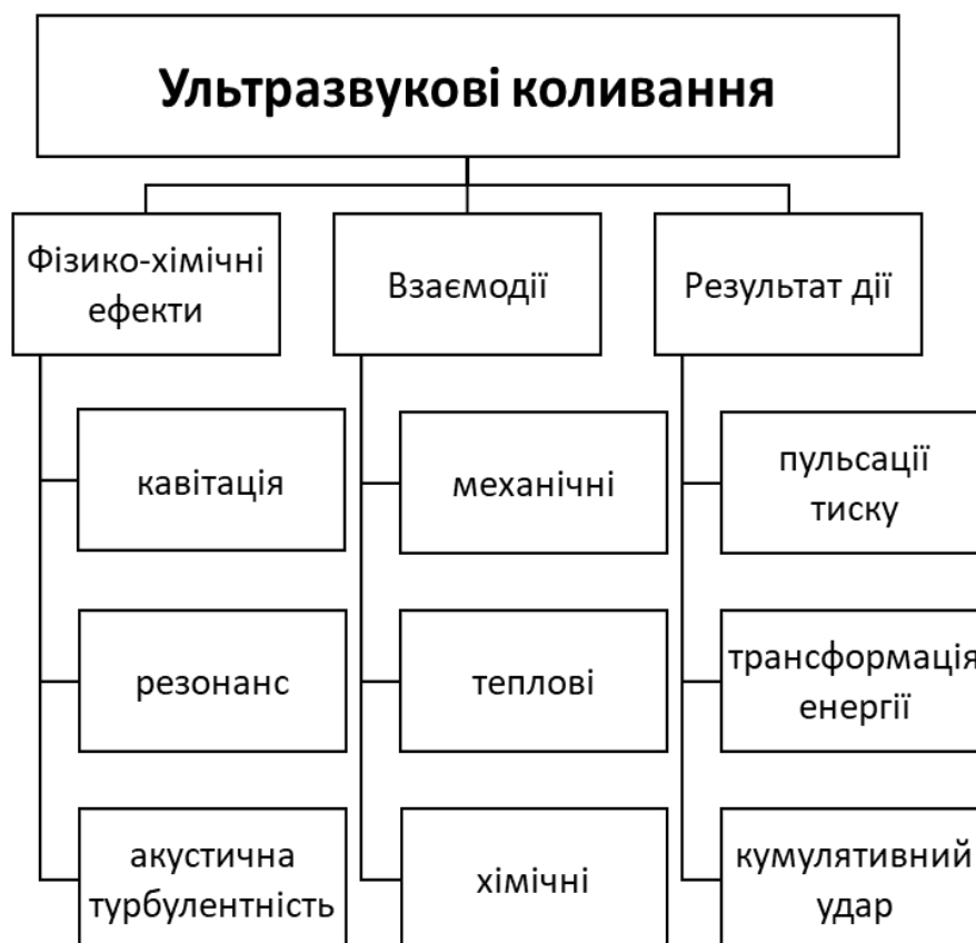
Рис. 1.6. Схема дії акустичних коливань на хіміко-технологічну систему
