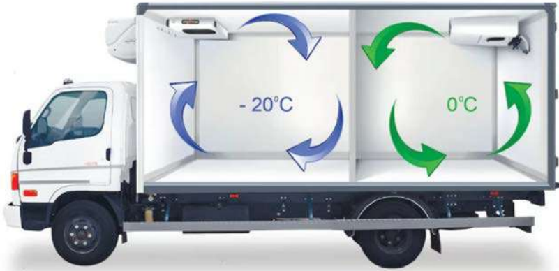
Рис. 14.8. Холодильний транспортний засіб, що охолоджується холодильною машиною
