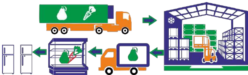
Рис. 14.2. Овочі та фрукти охолоджені у процесі транспортування: AXT \rightarrow PX \rightarrow AXT \rightarrow TXO \rightarrow БХО
