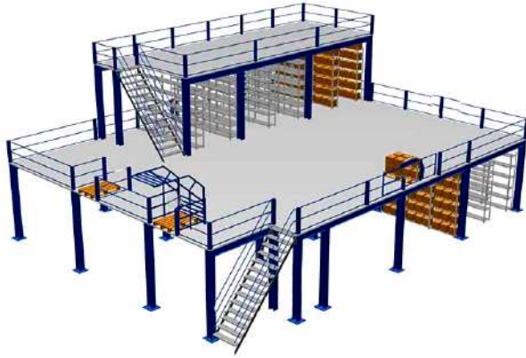
Рис. 7.11. Мезонінні стелажі: а – палетно-полочний; б – полочний; в – колонний
