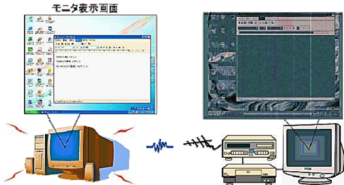
Рис. 19.3. TEMPEST-атака (можна віддалено проглядати екран вашого комп'ютера і мобільного телефону за допомогою радіохвиль)
