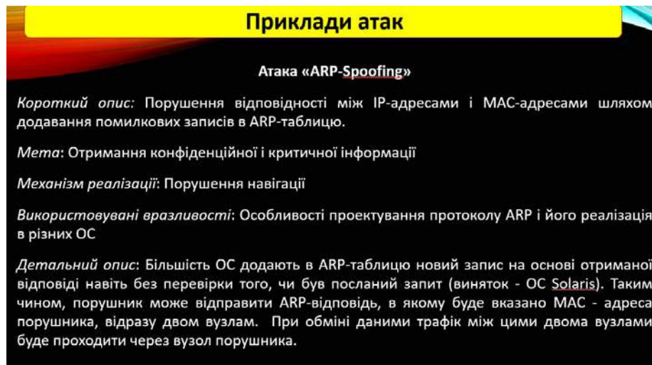
Рис. 6.4. Приклади атак «ARP-Spoofing»
