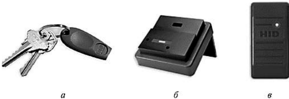
Рис. 21.3. RFID-брелок (а), програматор (б) та пристрій для читання (в)
