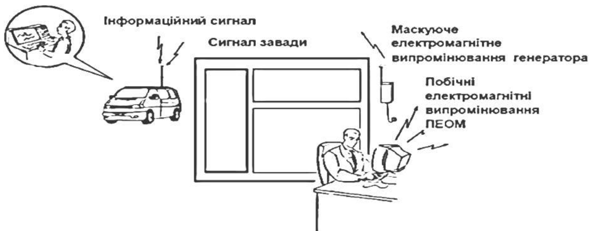
Рис. 19.4. Просторове електромагнітне зашумлення комп'ютерного місця
