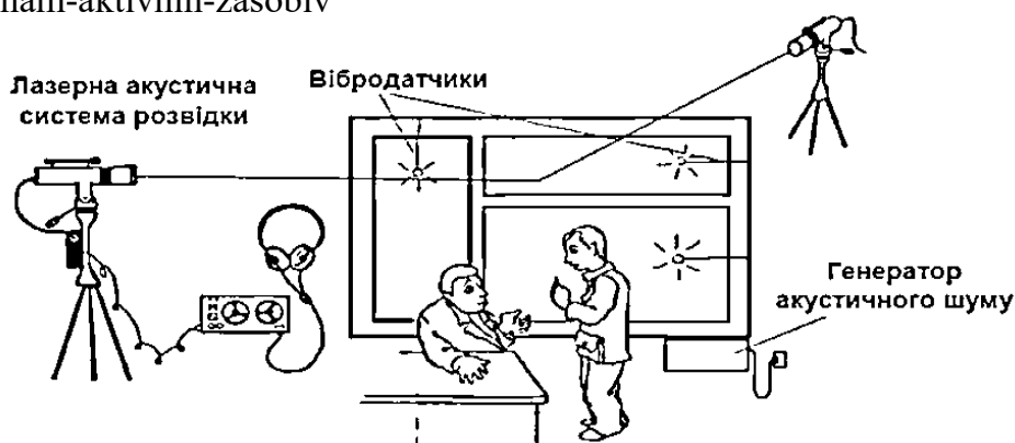
Рис. 19.6. Створення віброакустичних завад лазерній системі розвідки
