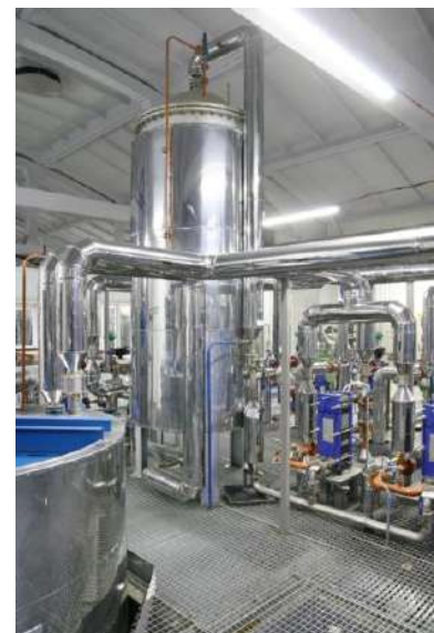
1 – адсорбер; 2 – насос; 3 – фільтр; 4 – пастка Рисунок 3.12 – Адсорбційна установка для очищення олії
