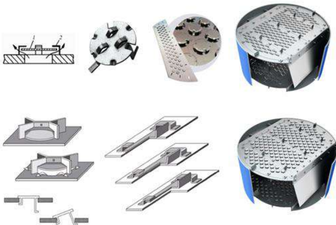
Рисунок 2.17. – Схема роботи клапана та вигляд елементів клапанної колони
