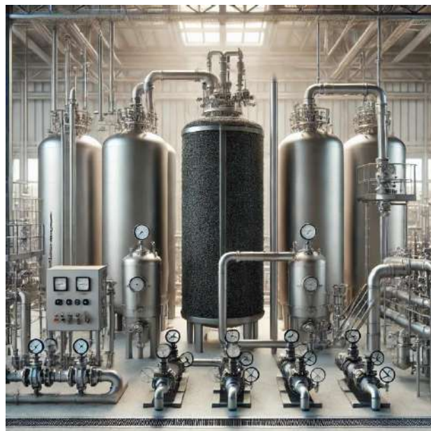
Рисунок 3.9. – Схема та загальний вигляд установки для очищення водно-спиртової суміші в нерухомому шарі активованого вугілля
