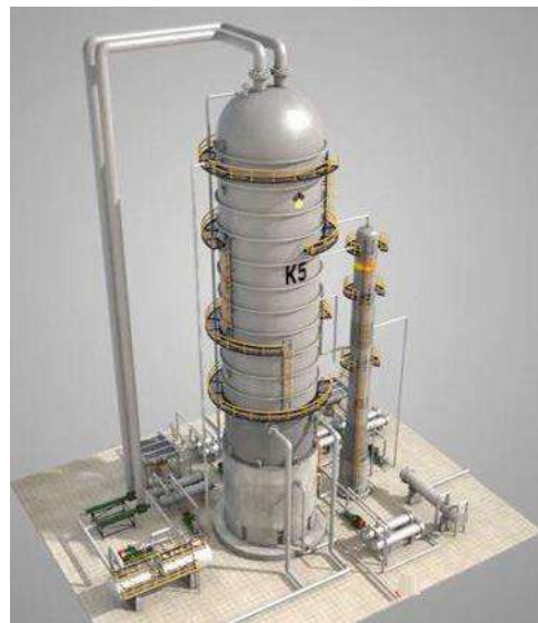
Рисунок 1.27. – Схема установки для екстрактивної ректифікації бінарної суміші
